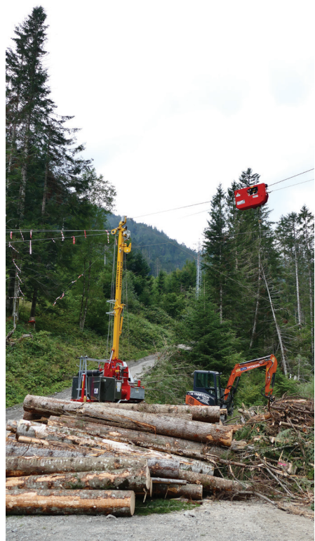
FIGURA 1 - Sinistra: esbosco con TR + verricello (archivio Compagnia delle Foreste S.r.l.). Destra: esbosco con gru a cavo a stazione motrice mobile (archivio Compagnia delle Foreste S.r.l.).
