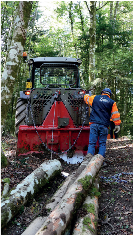
FIGURA 1 - Sinistra: esbosco con TR + verricello (archivio Compagnia delle Foreste S.r.l.). Destra: esbosco con gru a cavo a stazione motrice mobile (archivio Compagnia delle Foreste S.r.l.).
