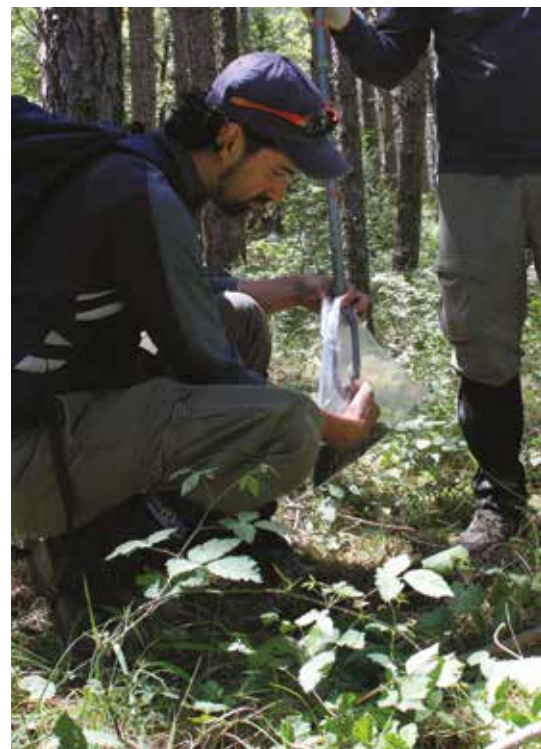
Prelievo del campione di suolo nello strato superficiale da 0 a 20 cm.
