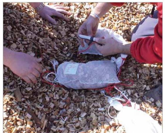
Foto 6 - Particolare nell'inserimento delle sonde e dei sottocampioni all'interno del cumulo.
