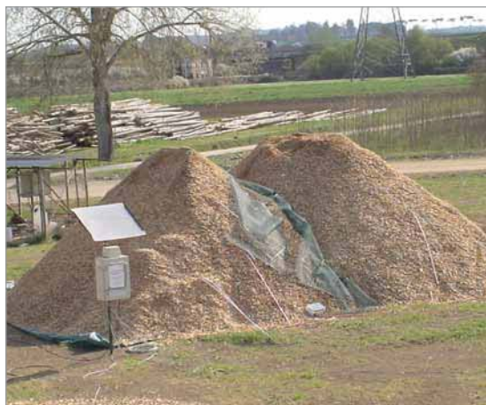
Foto 5 - Cumulo di cippato ad inizio sperimentazione. È possibile notare come il cumulo sia distinto in due semi-cumuli.
