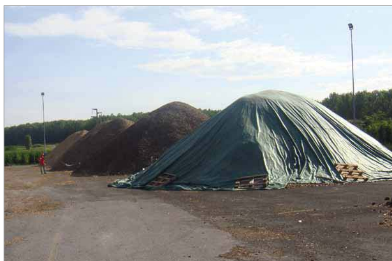
Foto 1 - Allestimento delle prove di stoccaggio per la comparazione fra cumuli scoperti e cumuli coperti con telo geotessile.
