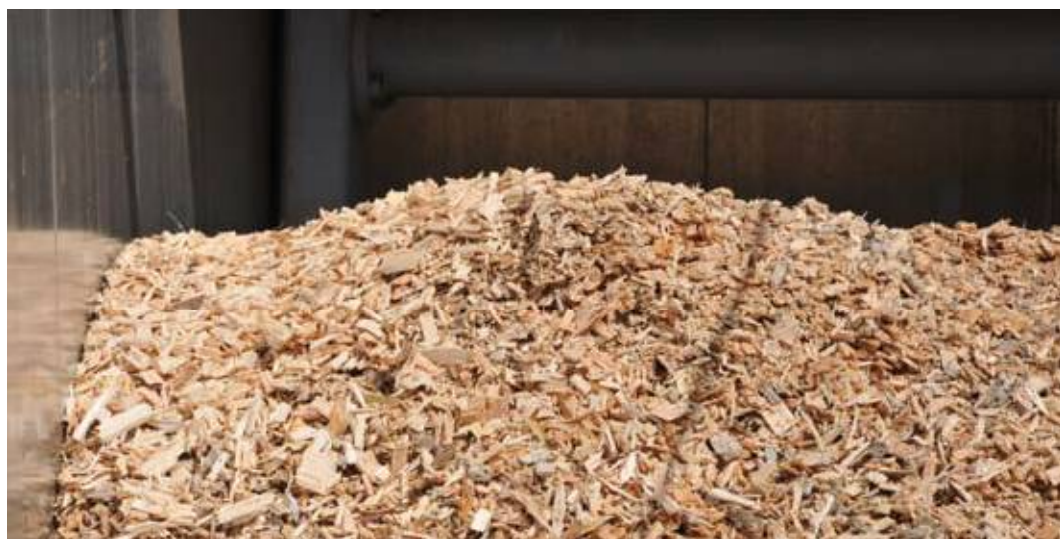
Cippato di differenti vagliature e gradi di essiccazione (Ditta Nelca, Calizzano - SV).
