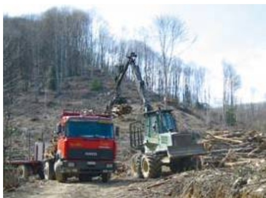
Un trasportatore forestale ( porteur ) che carica il bilico in bosco, presso il piazzale di cantiere (Ditta F.Ili Vinai, Mallare - SV).
