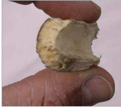
Foto 2 - Sezione trasversale di un chips di pioppo prodotto dal rotore CRA-ING.
