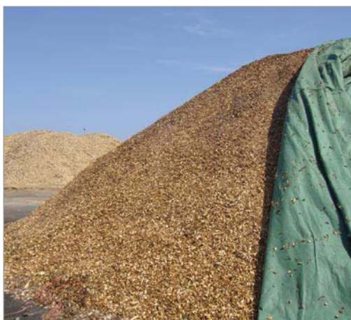
Foto 1 - Copertura del cumulo con telo geotessile.
