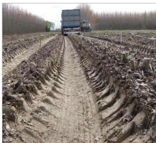
Foto 1 - Compattamento prodotto dal passaggio di una trattoria con rimorchio per il carico del cippato.
