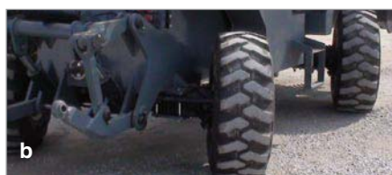
Foto 2 - Tipologie di sterzata: a) quattro ruote sterzanti, b) sterzata a granchio.
