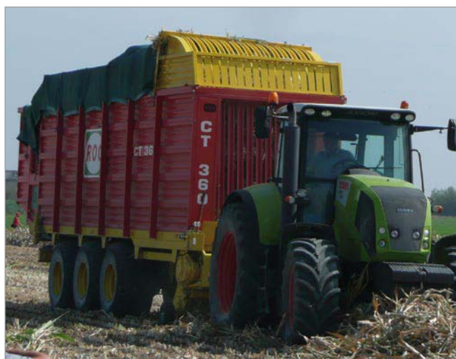
Foto 5 - Carro auto caricante per la raccolta del prodotto sfuso.
