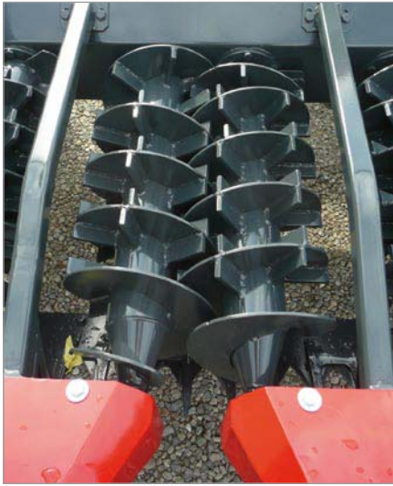
Foto 2 - Particolare del gruppo di condizionamento a coclee.
