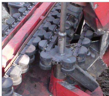
Foto 2 - Sistema di trasporto a catene gommate controrotanti.
