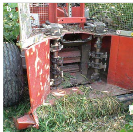
Foto 4 - Falciatrici-caricatrici equipaggiate con testate pick up per la raccolta delle piante abbattute ed andanate: a) Claas Jaguar 890, b) Spapperi mod. RT.
