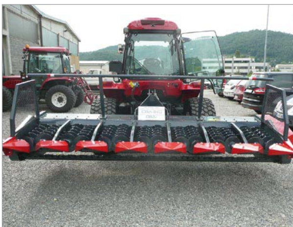
Foto 1 - Prototipo di falciaccondizionatrice realizzato da CRA-ING.
