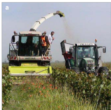
Foto 4 - Falciatrici-caricatrici equipaggiate con testate pick up per la raccolta delle piante abbattute ed andanate: a) Claas Jaguar 890, b) Spapperi mod. RT.
