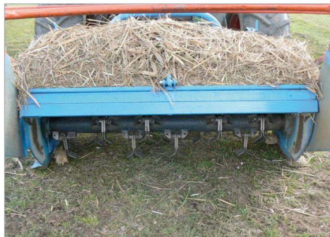
Foto 3 - Particolare dell'organo trinciante della Nobili.
