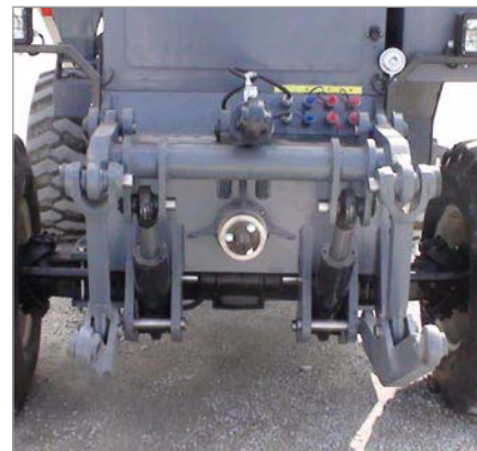
Foto 4 - Bracci anteriori per il collegamento delle testate da raccolta.
