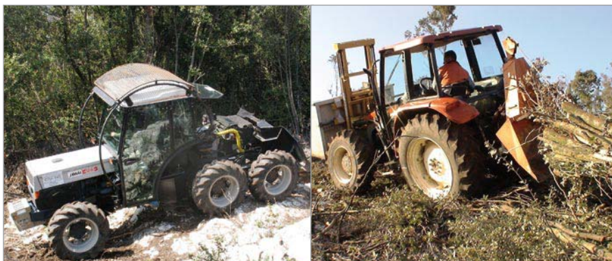
Foto 1 - Cantiere sperimentale di esbosco. A sinistra la trattrice LANDINI modificata (Tesi 1), a destra la trattrice NEW HOLLAND (Tesi 2).
