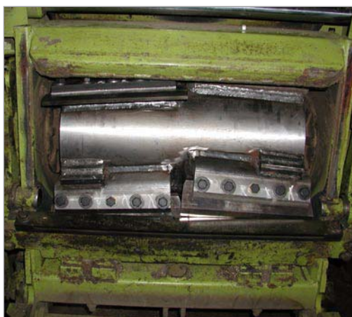
Foto 1 - Rotore CRA-ING montato su Claas Jaguar 890.
