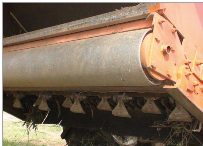
Foto 3 - Particolare del rullo di appoggio e dell'organo trinciante.
