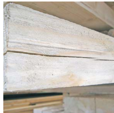
Fessura longitudinale su segato Fente longitudinale sur sciage
