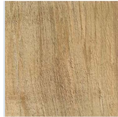
Sobbollimento su segato Echauffure sur sciage
