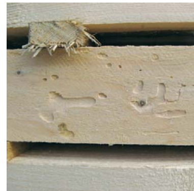
Gallerie d'insetti su segato Galleries d'insecte sur sciage
