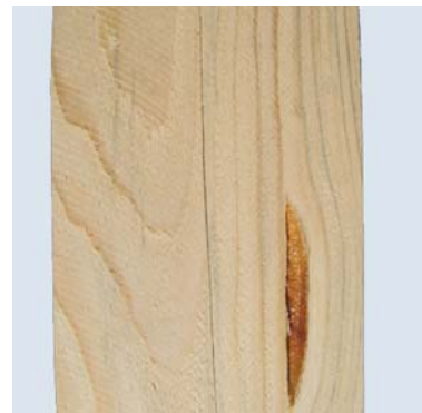
Tasca di resina su segato Poche de résine sur sciage
