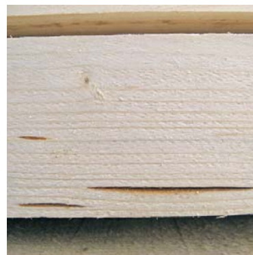
Tasche di resina su segato Poche de résine sur sciage
