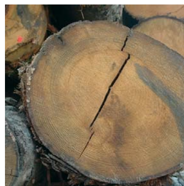
Fessura da ritiro su testata di tondo Fente en bout sur bois rond
