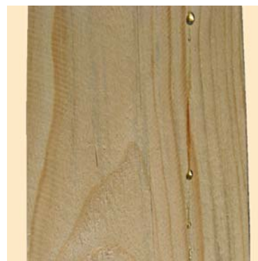
Colatura di resina su segato Exsudat de résine sur sciage
