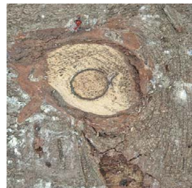
Nodo non aderente su tondo Nœud non-adhérent sur grume
