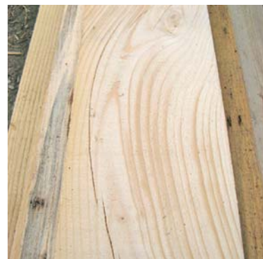
Fibratura deviata su segato connessa alla presenza di canastro Pente de fil anormale
