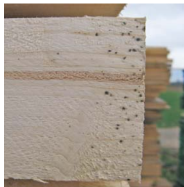
Presenza di midollo su segato- sezione longitudinale Moelle sur sciage (section longi- tudinale)
