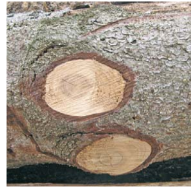
Nodi sani e aderenti su tondo Nœud sain et adhérent sur grume
