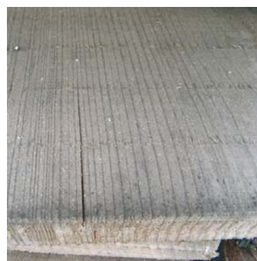
Alterazione del colore dovuta ad agenti meteorici su segato Discoloration sur sciage occasionnée par des agents atmosphériques
