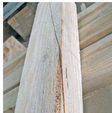
Sventa su segato Fil helicoidal sur sciage
