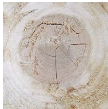
Nodo ovale sano e aderente su segato Noeud ovale sain et adhérent sur sciage
