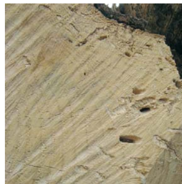
Attacco di insetti su tondo Attaque d'insecte sur bois rond
