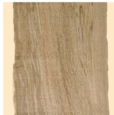
Sobbollimento su segato Echauffure sur sciage
