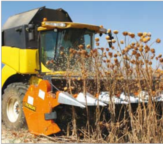
Foto 4 - Mietitrebbiatrice equipaggiata con testata da cardo idonea alla raccolta separata dei capolini (convogliati al gruppo di trebbiatura) e degli steli (depositati in andana).
