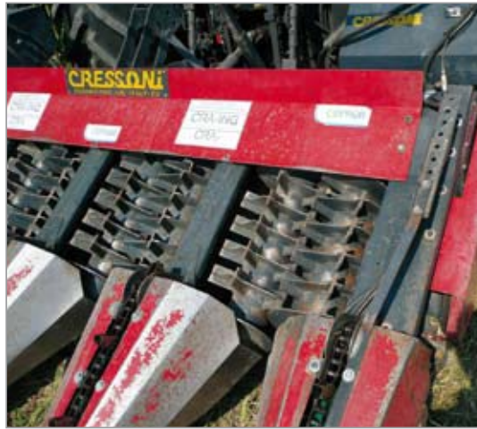
Foto 5 - Particolare del sistema di falciacondizionatura sviluppato dal CRA-ING per colture di altezza superiore ai 2 metri a stelo spugnoso.
