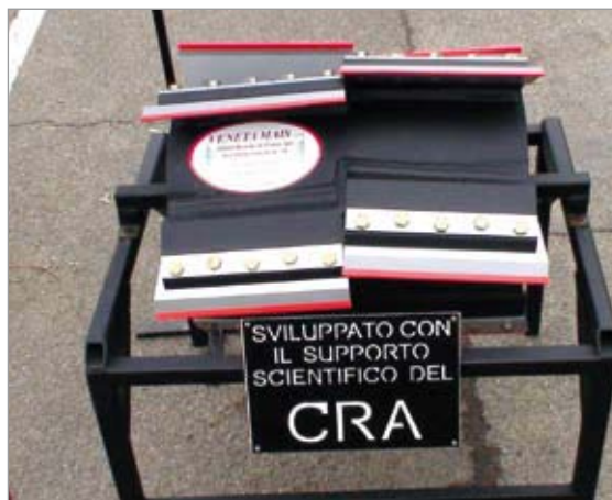
Foto 1 - Rotore CRA ING. Da notare il minor numero di portacoltelli e il diverso angolo di inserzione dei coltelli rispetto al rotore di serie.
