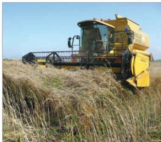
Foto 3 - Raccolta del colza mediante mietitrebbiatrice con separatore laterale a lama mobile.
