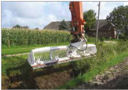
Foto 12 - Cesta falciante proposta dalla casa tedesca Michaelis montata su escavatore gommato (fonte: www.dennisbarnfield.co.uk .)
