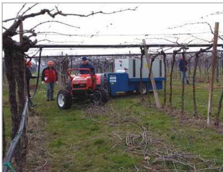
Foto 1 - Trincia-raccogli-sarmenti. Costruzioni Nazzareno, modello MAREV Alba 150.
