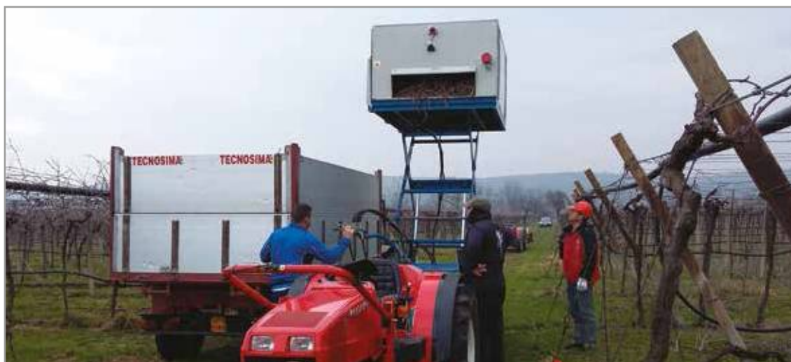
Foto 3 - Scarico del cassone con sollevamento a pantografo doppio.
