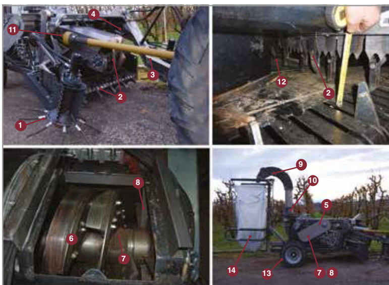
Foto 1 - 1) Rulli andanatori (opzionale); 2) rullo e catena di raccolta; 3) timone per il traino anteriore; 4) cilindro di regolazione dell'altezza di raccolta; 5) scambiatore olio idraulico con ventola elettrica; 6) coclea cippatrice con coltelli elicoidali; 7) albero coclea cippatrice; 8) ventola lanciatrice; 9) tubo lanciatrice con terminale orientabile; 10) ralla tubo lanciatrice; 11) presa di forza; 12) rulli alimentatori; 13) pneumatici; 14) accessorio posteriore (opzionale).
