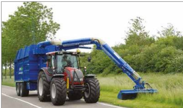
Foto 2 - Trincia-aspiranti della ditta Hemos durante le operazioni di sfalcio dell'erba, (fonte: www.hemos.nl ).
