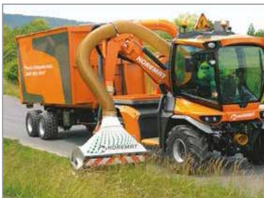
Foto 6 - Il modello VSV proposto dalla ditta Noremat durante la fase di lavoro (fonte: www.noremat.fr ).
