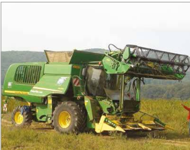
Foto 1 - Mietitrebbia John Deere Mod.W66, con testata superiore JD 613R ad altezza massima di taglio e testata inferiore tipo Kemper.
