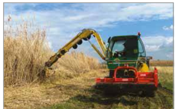
Foto 11 - Macchina semovente idrostatica Energreen ILF S 1500 (fonte: CREA-ING).
