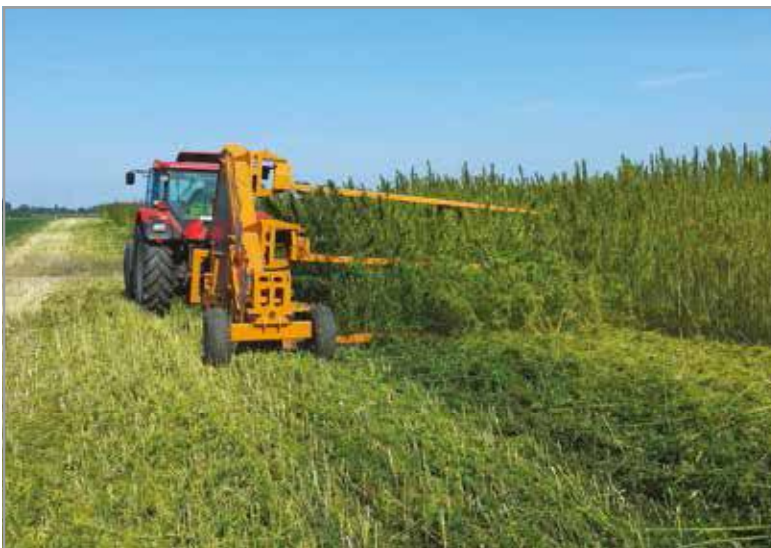
Foto 4 - Sistema di taglio a tre barre falcianti in azione © Jacek Kołodziej.
