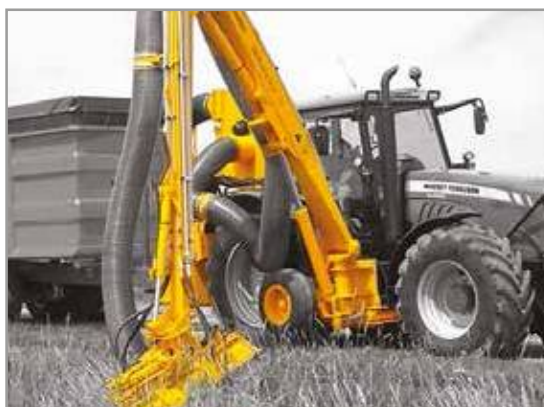
Foto 5 - Modello "Grenadier" della ditta olandese Herder, con particolare della testata trinciante (fonte: www.herder.nl ).
