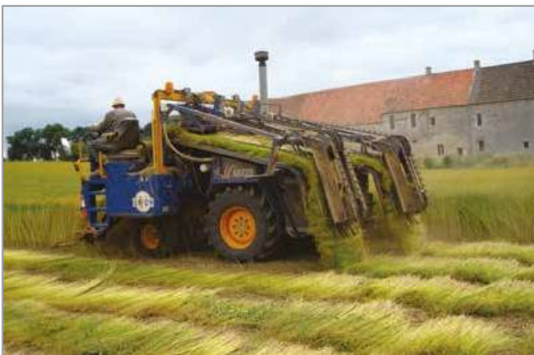
Foto 2 - Puller semovente in fase di lavorazione. In basso a sinistra il particolare delle piante lasciate allineate in andane © Union.
