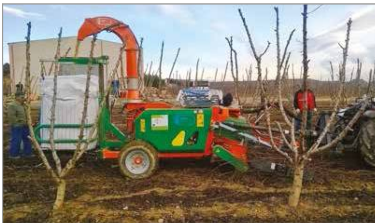
Foto 3 - Macchina in fase di lavoro - Configurazione con big-bag.
