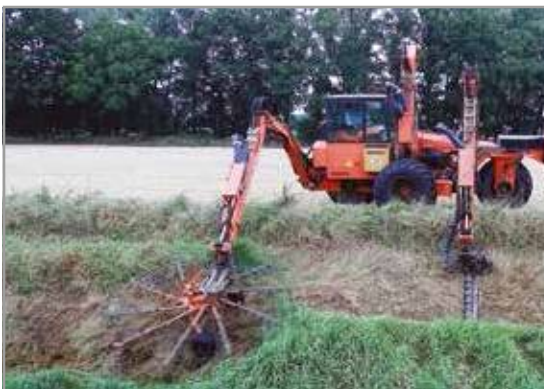
Foto 4 - Sfalcio e immediato trasporto della vegetazione sul piano della sponda con nastro trasportatore o ranghinatore rotativo (fonte: www.berky.de ).
