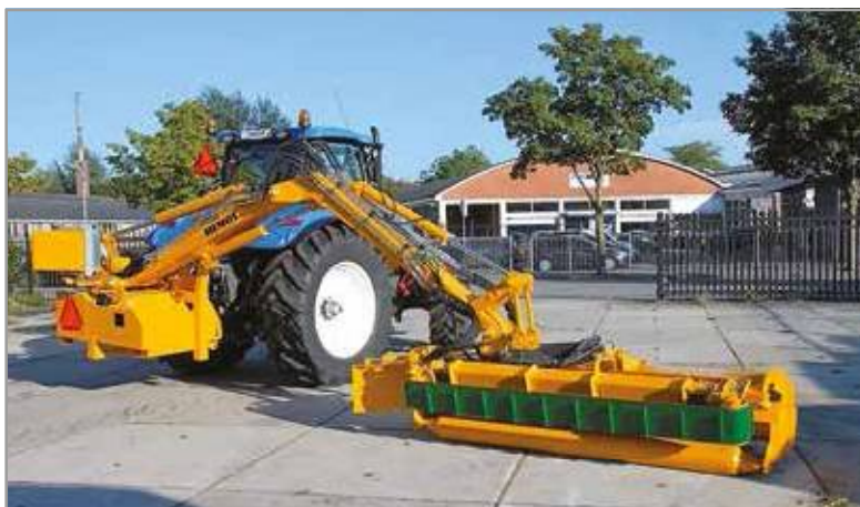
Foto 3 - Trinciasarmenti con nastro trasportatore della ditta Hemos (fonte: www.hemos.nl ).
