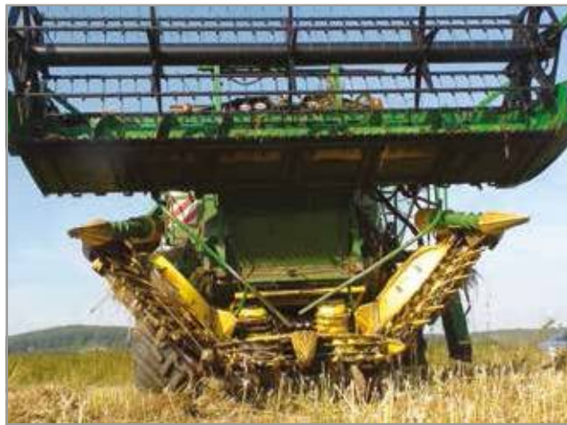
Macchina per la raccolta e separazione delle diverse frazioni ottenibili dalla coltivazione della canapa.
