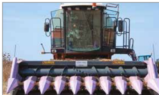
Foto 2 - Prototipo di nuova concezione per la raccolta del cardo a barra flessibile.
