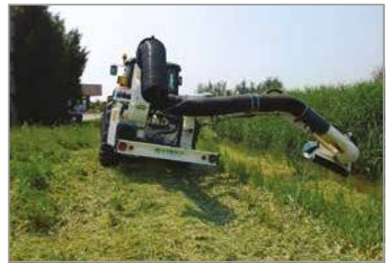
Foto 9 - La macchina in fase operativa con il prodotto trinciato che può essere disposto in andana sul piano orizzontale della sponda oppure convogliato direttamente in un cassone trainato (fonte: CREA-ING www.hymach.it ).
