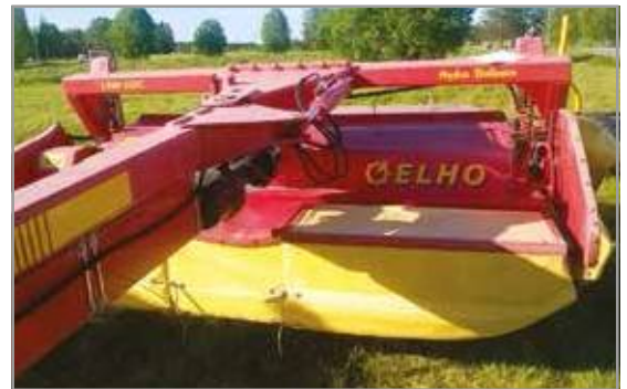
Foto 10 - La falciatrice a 8 dischi di taglio HNM 320 C della ELHO (fonte: www.mascus.com ).
