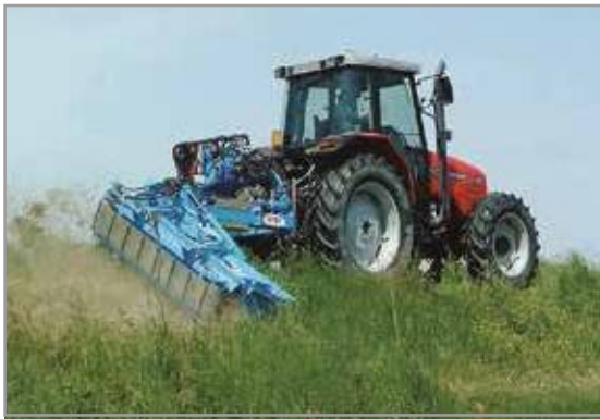
Foto 7 - Trinciasarmenti con nastro trasportatore prodotto dalla OSMA (fonte: MAD Ottobre 2009).
