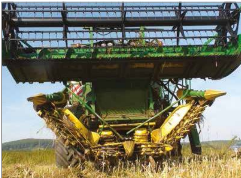
Foto 2 - Particolare frontale della mietitrebbia con testata inferiore sollevata in modalità di trasporto.
