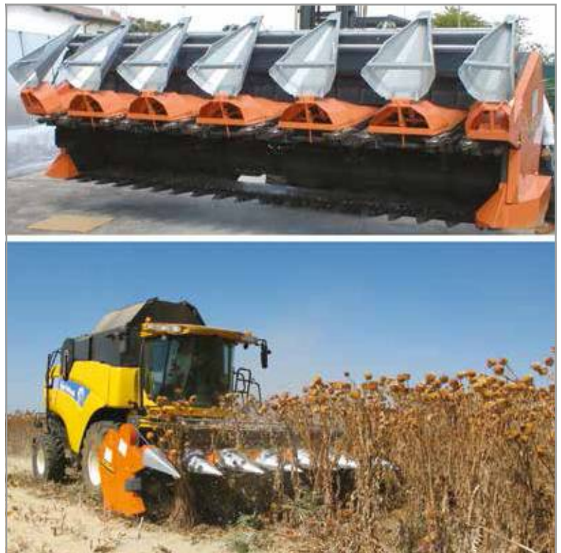
Foto 1 - In alto particolare del prototipo, in basso il prototipo durante le fasi di raccolta.
