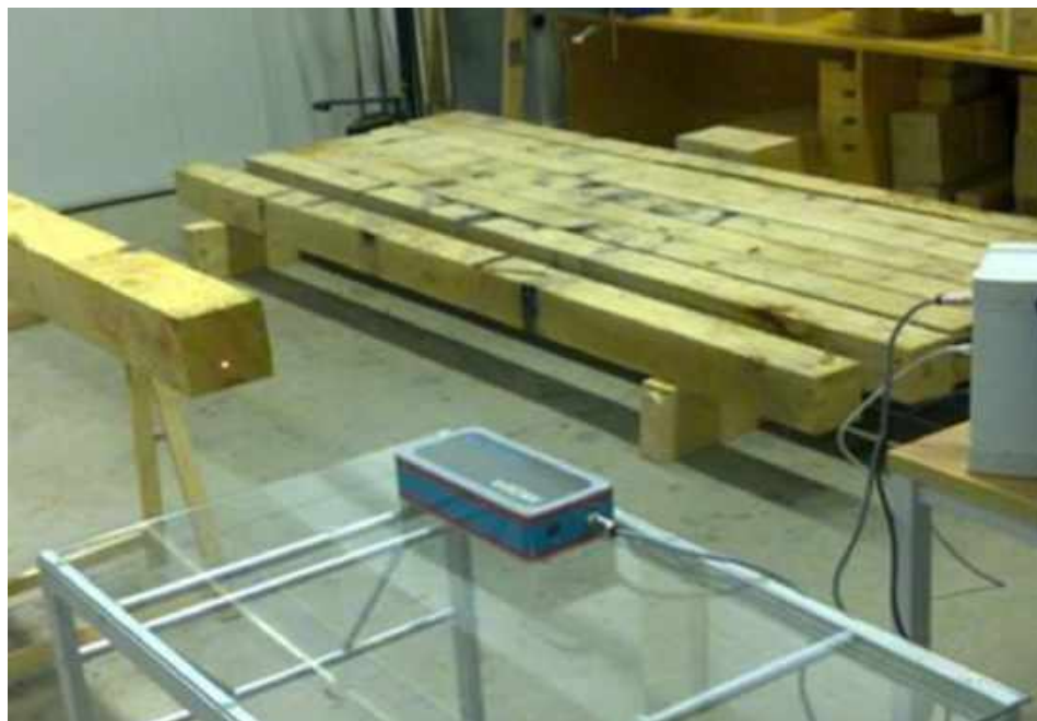
Figura 3. Classificazione a macchina di segati per uso strutturale.
