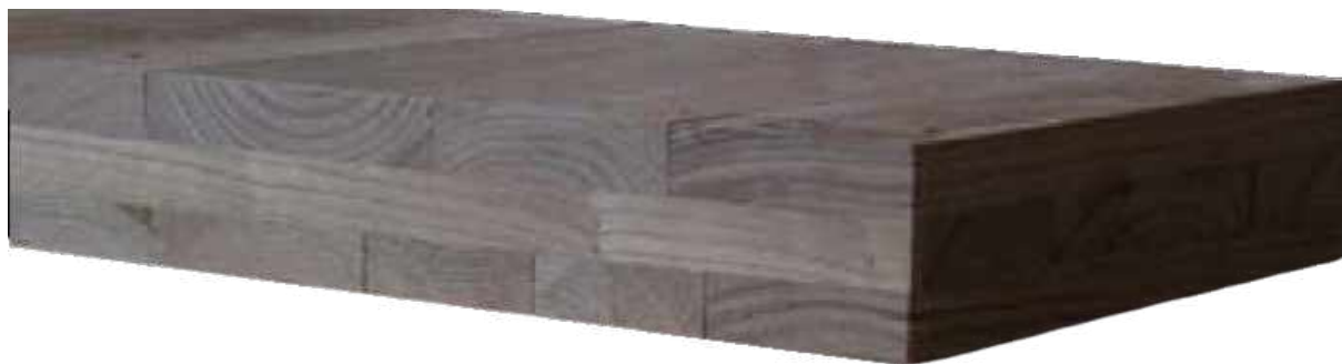
Figura 1. X-lam di castagno di provenienza regionale realizzato nell'ambito di uno studio sperimentale svolto da DiSAFA - Università di Torino e DAD - Politecnico di Torino.
